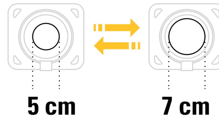
Le joint flexible du WUNDERBAG accepte facilement les orifices d'aspirateur allant de 5 à 7 cm de diamètre.
